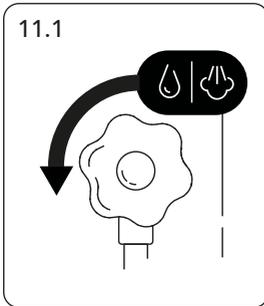
Drehen Sie die Knöpfe (3 oder 12) gegen den Uhrzeigersinn, um Dampf und heißes Wasser auszugeben (Abb. 11.1).
