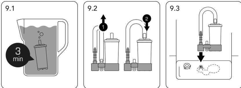
Bevor Sie den Harzfilter (H) im Tank (10) installieren, tauchen Sie ihn etwa 3 Minuten in einen Behälter mit frischem Wasser, um zu verhindern, dass die Luft im Inneren des Filters eine Fehlfunktion der Maschine verursacht (Abb. 9.1).
