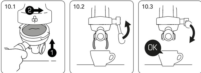
Nehmen Sie den Siebträger (G) aus der Ausstattungsbox, legen Sie das Sieb ein, welches Sie verwenden möchten, und füllen Sie es mit der Menge von gemahlenem Kaffee, die dem von Ihnen gewünschten Sieb entspricht. Verwenden Sie den Tamper (D), um den Kaffee im Filter zu verdichten. Spannen Sie den Siebträger (G) in die Brühgruppe ein (13) und stellen Sie sicher, dass der Griff des Siebträgers mit dem Vorhängeschloss-Symbol auf der Kaffeeabgabereinheit ausgerichtet ist (Abb. 10.1).
